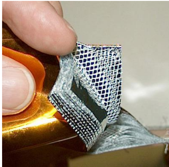
1.7. ábra: Multi-layer insulation szerkezete [13]
