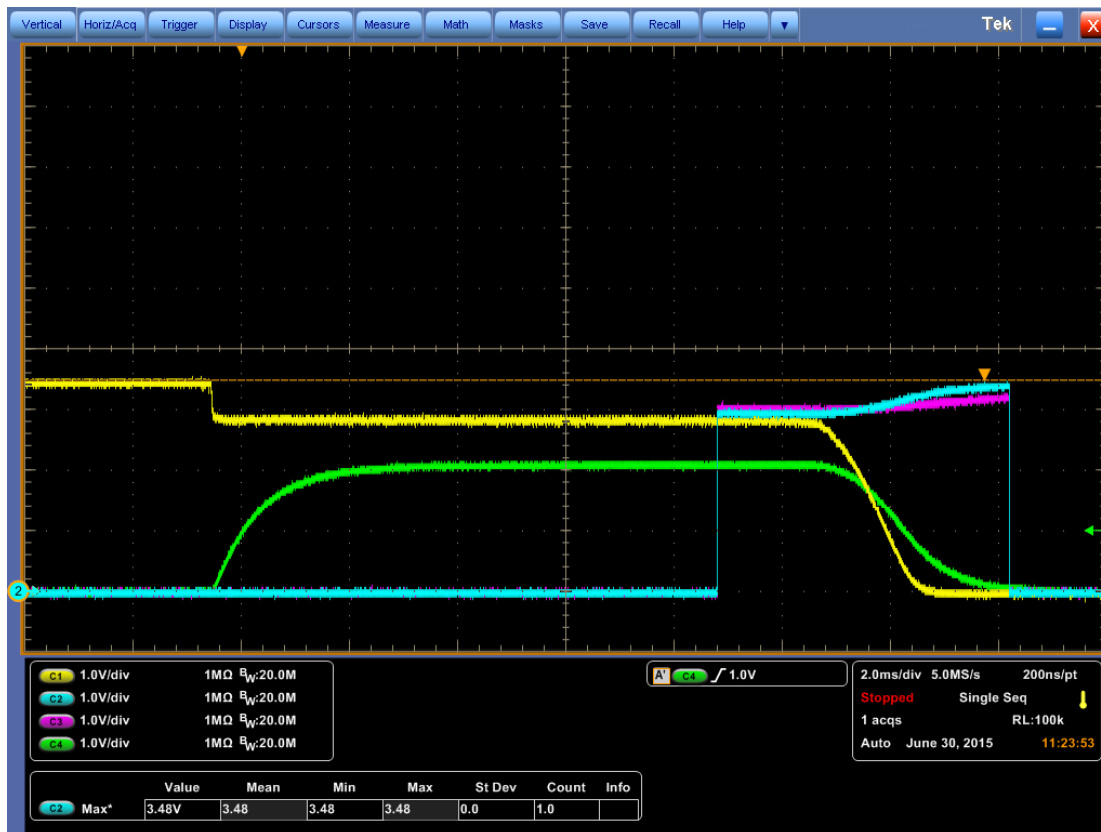
4.26. ábra: A LSW/B kapcsoló áramkör vezérlő jelfolyama oszcilloszkópon
