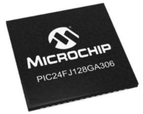
4.37. ábra: A kiválasztott mikrokontroller
