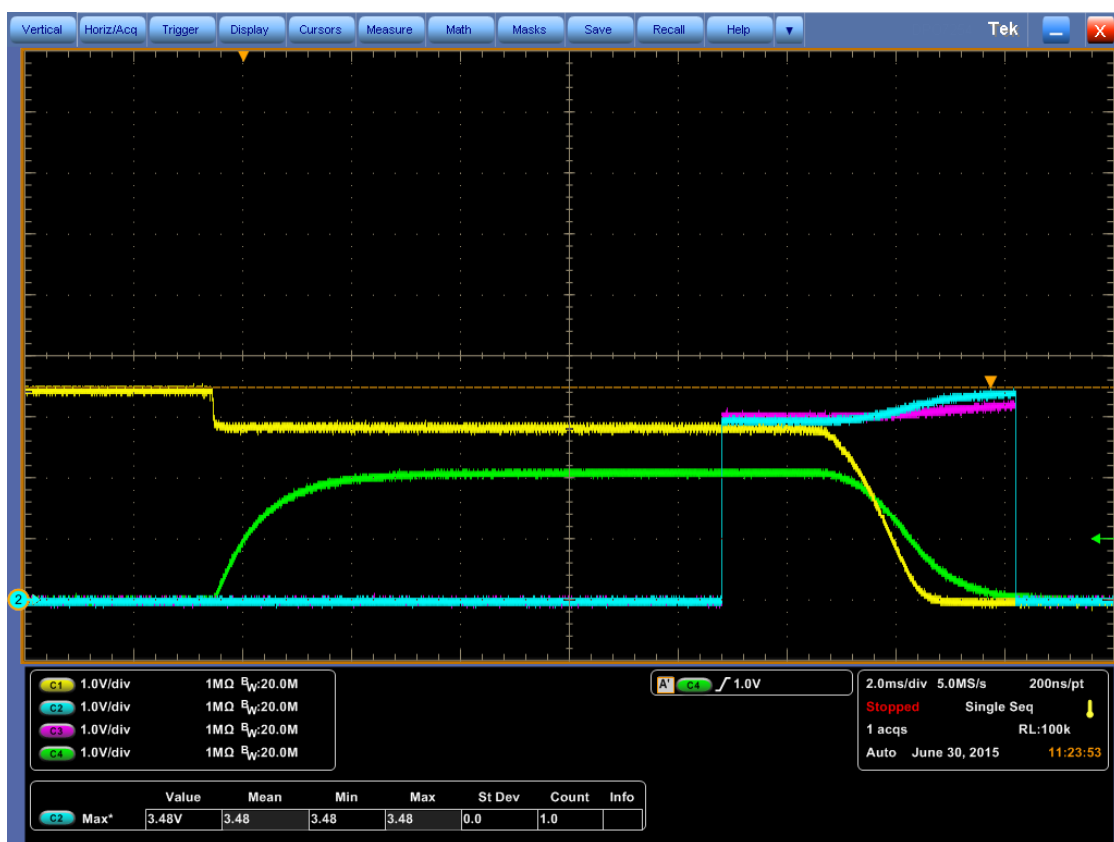
4.27. ábra: A túláram védelmi kapcsoló áramkör vezérlő jelfolyama túláram esetén oszcilloszkópon
