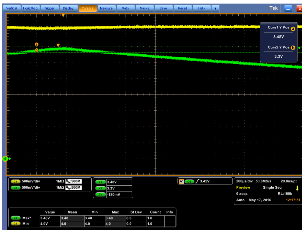
5.4. ábra: A túlvezetés védelem működésének jelalakjai a tápegység kapcsoló transzisztorának zárata esetén
