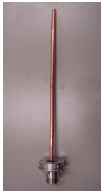
10. ábra A földlap és az illesztő koaxiális kábel a hozzá tartozó meleg érrel
