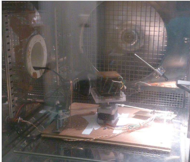
6.11. ábra. A hőkamrás mérés elrendezése
